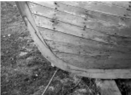
*La rehabilitación debe dar respuesta coherente a problemas concretos. Roda de embarcación unida en rayo de Júpiter. Ría de Arosa. Septiembre de 1996.*
