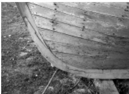
A rehabilitación debe dar resposta coherente a problemas concretos. Roda de embarcación unida en raio de Xúpiter. Ría de Arousa. Setembro de 1996.
