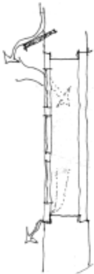
O sinxelo principio de estanquidade da fiestra enrasada, a cámara drenante, é empregado hoxe nas máis avanzadas carpinterías de aluminio.
