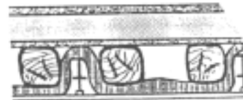
Diferentes solucións de illamento acústico do entramado de madeira. Ensaíouse con éxito o falso teito de dobre taboleiro de cartón xeso de diferente grosor, suspendido con ancoraxes elásticas, sobre o que se coloca unha manta de fibra de vidro. Debuxos facilitados por José Luis González Moreno-Navarro. Arquitecto.
