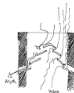
Sección da cheminea tradicional. O solape das lousas de pedra impide a entrada da auga ó interior.
