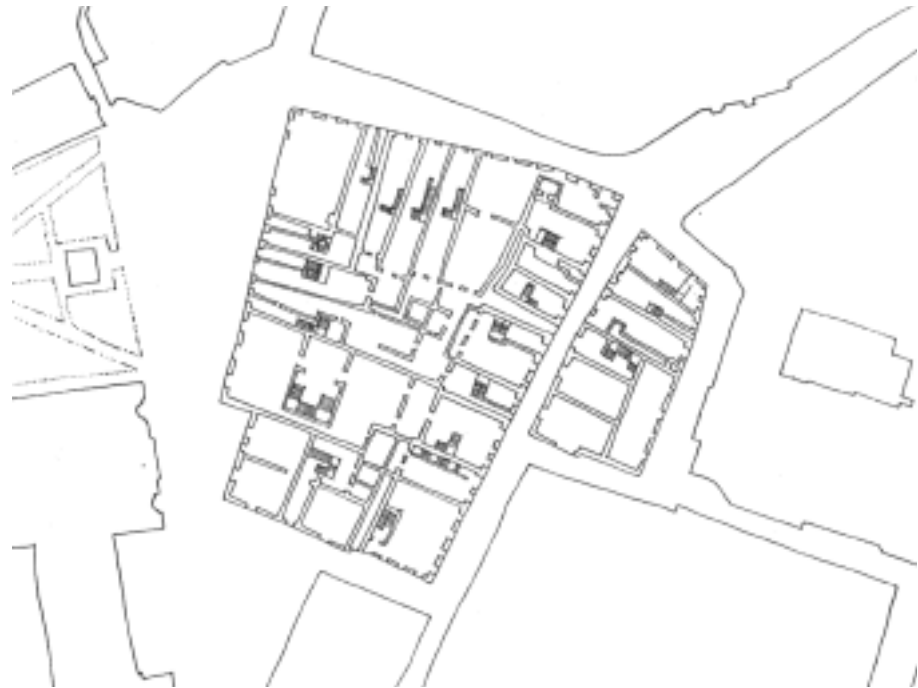
A estabilidade dos muros medianeiros tamén depende da disposición destes no conxunto da mazá.
