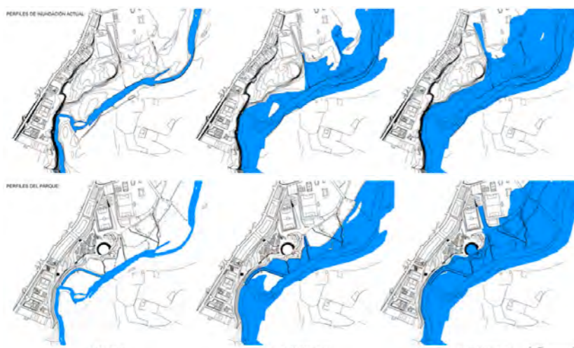
Planos de modelización de la superficie de laminación del río Gállego a su paso por el municipio de Zuera en Aragón, en el estado original del cauce del río y con las posteriores obras del parque de ribera (aldajover Arquitectos).
