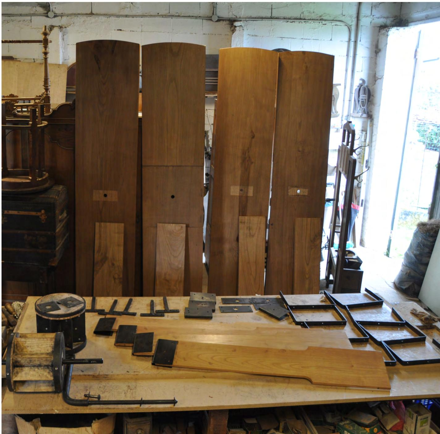
Todas las piezas se unen o bien mediante clavos o bien cajeado. Y abrazadas mediante cintas de acero. Todas las piezas base de madera debían de partir, antes del desbaste, de un volumen que no necesite una talla superior al 20%. En el caso de las lengüetas, la talla de estas no debería exceder el 10%.
