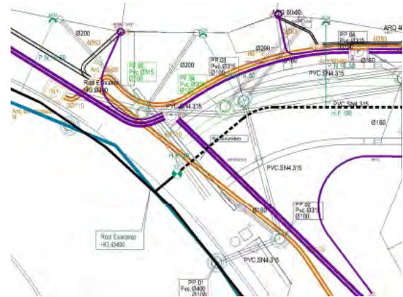
la densidad de redes presentes en el subsuelo de la ciudad es enorme por lo que se hace urgente su racionalización
